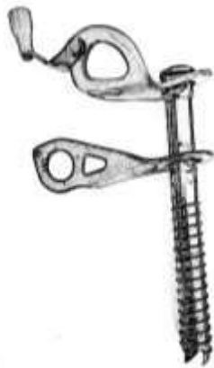
Рисунок 20. Использование ледобура с дополнительной проушиной для карабина
